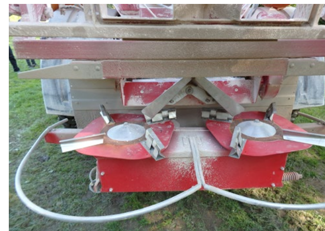
Obr. 2: Detail rozmetacího ústrojí u kotoučového rozmetadla Bredal, řady K (typ K105L Auger). Foto © David Šimek (5. října 2021)
