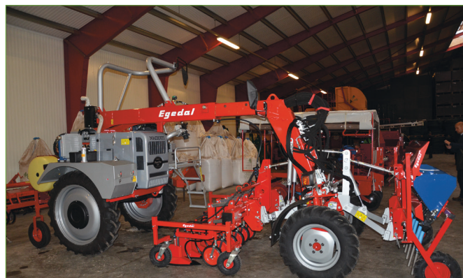
Obr. 3: Speciální nosič meziřádkového postřikovače a kulturačních adaptérů pro kombinaci pletí a herbicidního ošetření.
